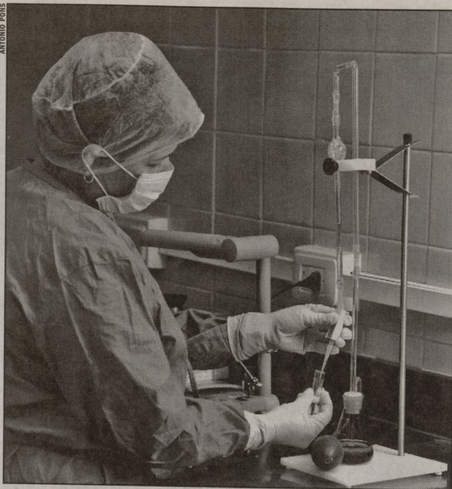
La leche es analizada en el laboratorio para determinar, entre otros parámetros, el grado de acidez que posee.
